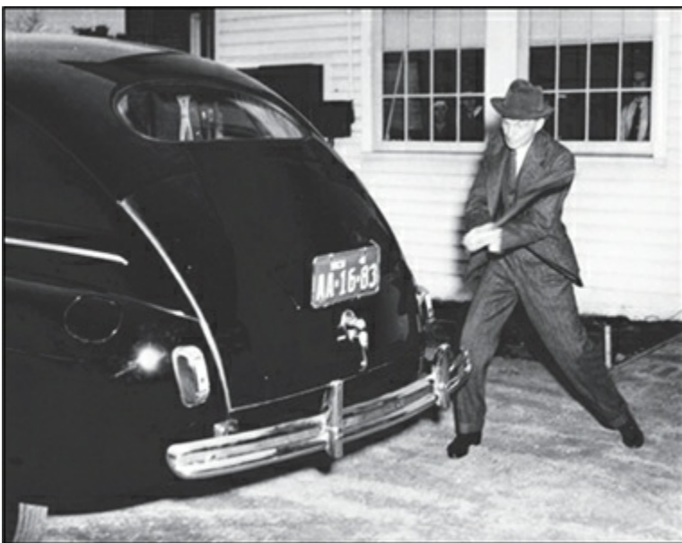
Abb. 91: Das „Plastikauto“ von Ford. Die leichte Karosserie ist 10-mal stärker als Stahlblech. Selbst heftige Hammerstöße hinterlassen keine Beulen. Einen Videolink finden Sie im Quellenverzeichnis. (34)
